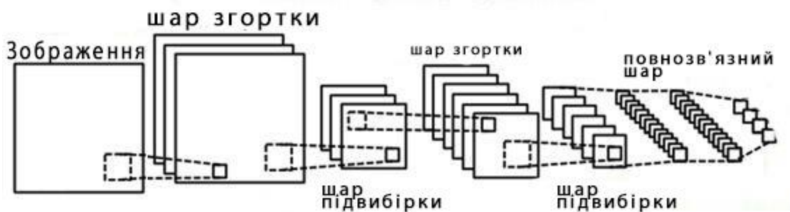
Рисунок 1 - Структура згортувальної нейронної мережі
